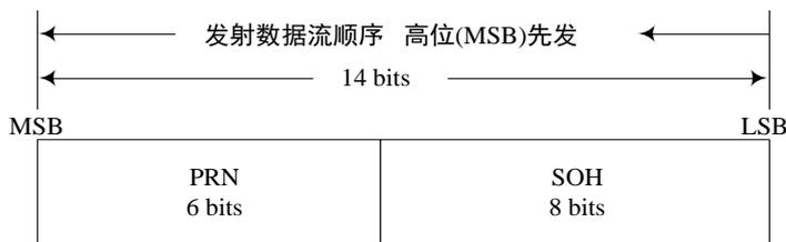
图 6-5 B-CNAV1 子帧 1 信息编排格式
