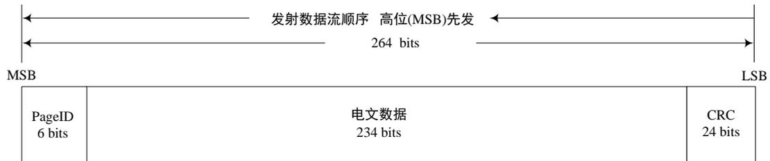
图 6-7 B-CNAV1 子帧 3 的帧结构
