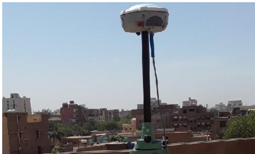
图 5 SUDN 站数据采集设备
