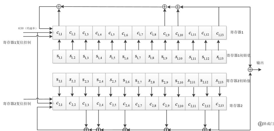
图 5-1 B2b 信号 I 支路测距码发生器
