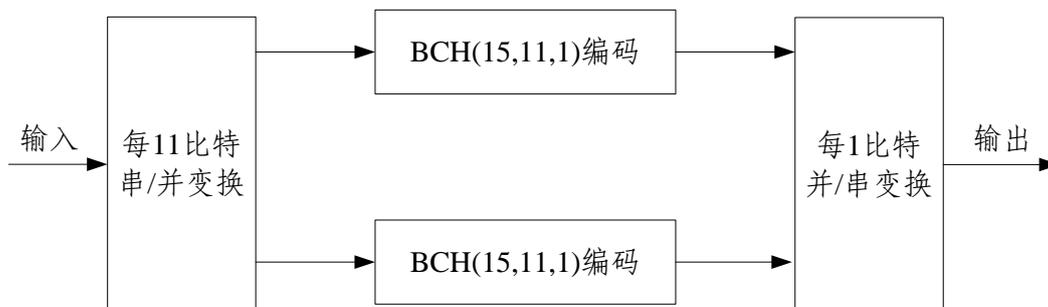
图 5-1 导航电文纠错编码示意图
