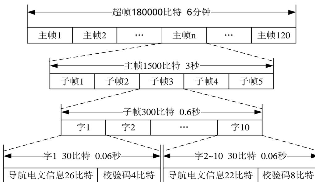
图 5-12 D2 导航电文帧结构
