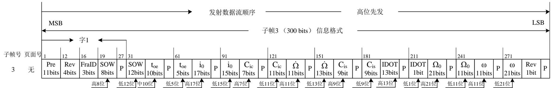
图 5-10 D1 导航电文子帧 3 信息格式编排
